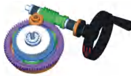
差齿行星齿轮传动、无离合手轮
