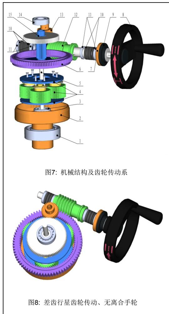
图7: 机械结构及齿轮传动系
