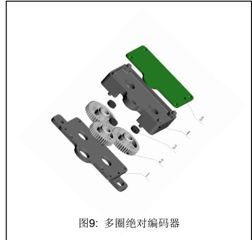
图9: 多圈绝对编码器
